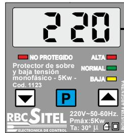
Ejemplo de Voltaje Medido en la red MONOFÁSICA [VTrms]: 220 V(TRMS)
