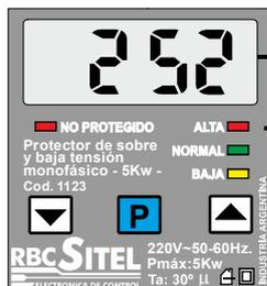
VALOR DE TENSIÓN DE **CORTE POR ALTA** AJUSTADO DE FÁBRICA
