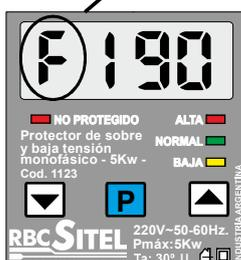
Ejemplo: La tensión en la red es de 185 V y se desea ajustar el corte en 190 V se observa en el display:
